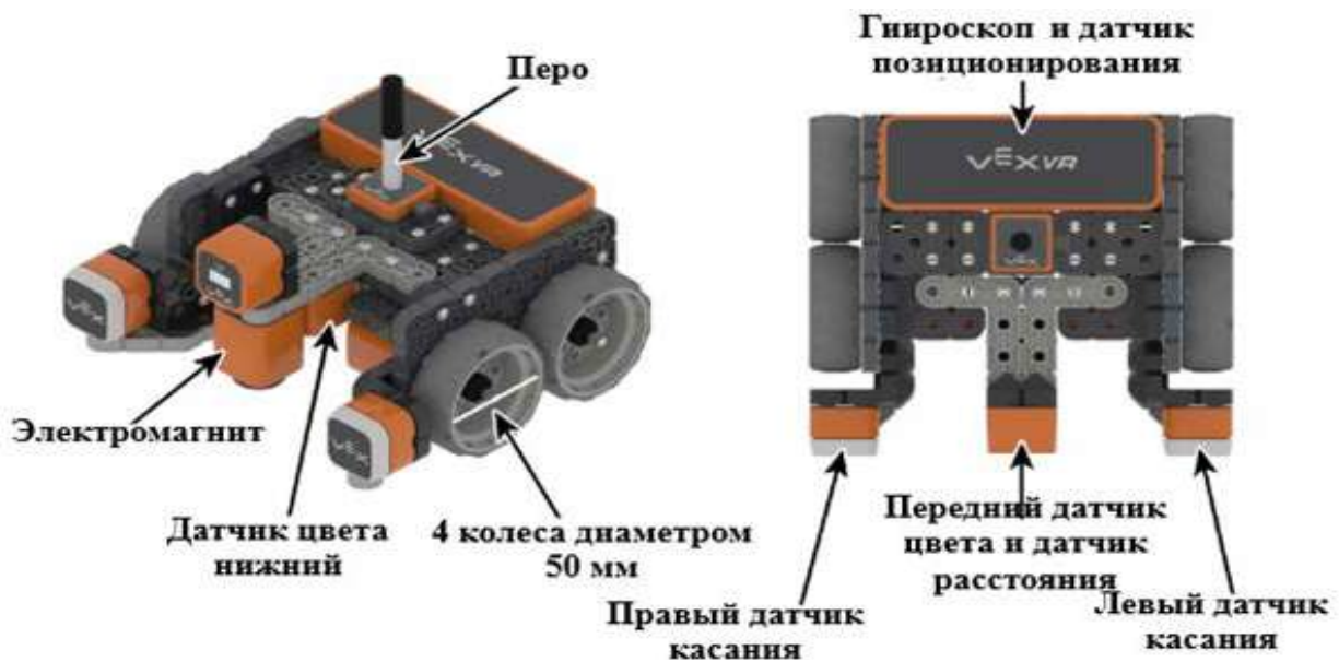
Рис. 7. Конфигурация датчиков робота
